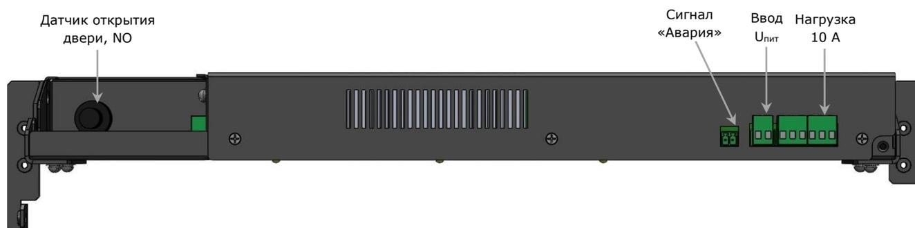
Рисунок 2 – Подключение термощкафа
